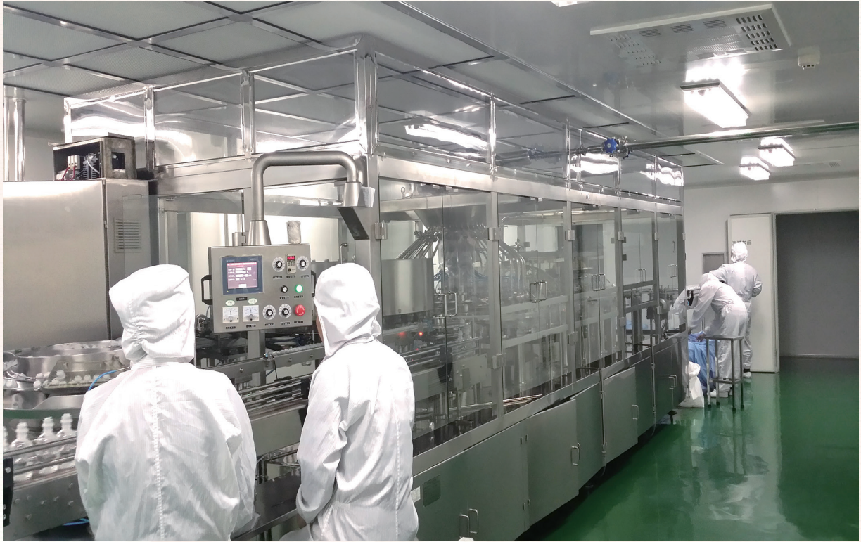
甘肃扶正药业科技股份有限公司塑料瓶生产线洗濯封机
