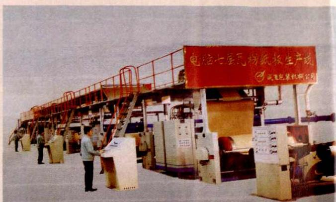
天水新华印刷厂高速瓦楞纸板生产线
