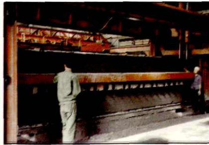
甘肃省硅酸盐制品厂切割机及所产加气混凝土砌块
