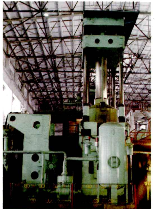
兰州炭素厂3500吨电极挤压机
