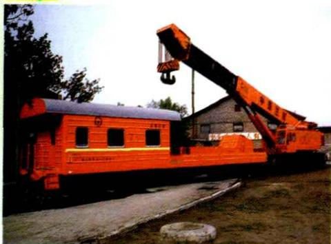
1988年,兰州机车厂研制成功N1004型全液压伸臂式铁路起重机,最大起重能力为100吨。
