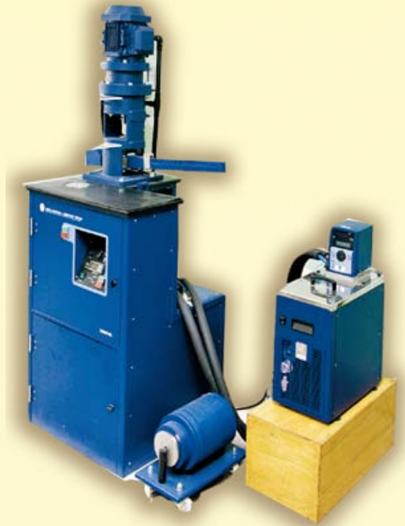
西塔cecl45轴承剪切实验机
